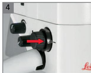
4 Bez gledanja u okulare, odredite minimalno uvećanje (6.4x). Slika na monitoru mora ostati oštra.
