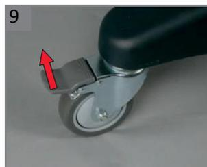
Otpustite nožne kočnice.
