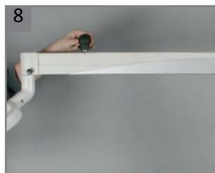
Olabavite kočionu tipku za zaključavanje vertikalnog položaja.
