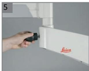
5 Otvorite zglobnu kočnicu.
